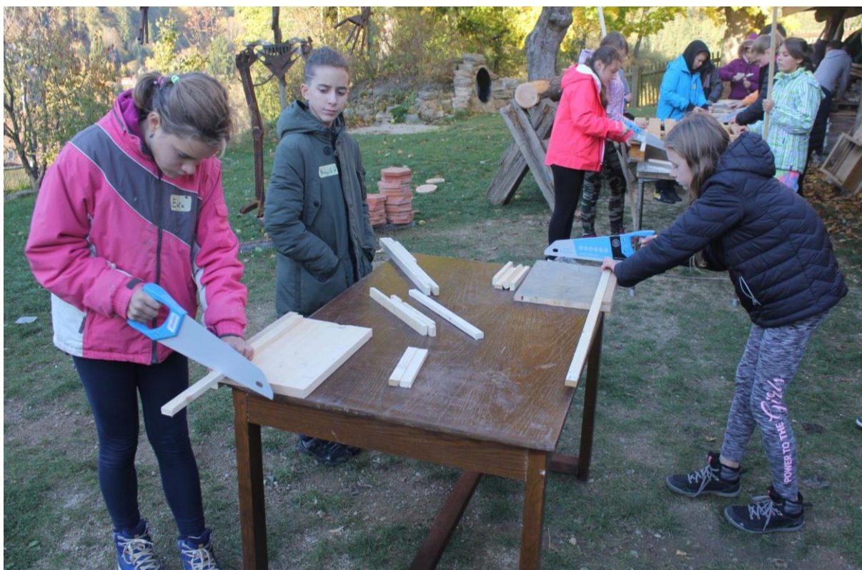
Řezání pilkou ocaskou, latě jsou fixovány proti pohybu v řezacích přípravcích.
